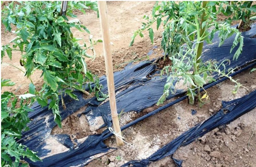
**Figura 11.** Cobertura de bioplástico com fissuras na superfície
