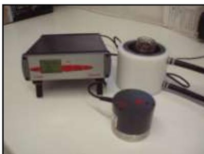
**Figura 8.** Determinação da atividade da água dos recheios de bombons.
