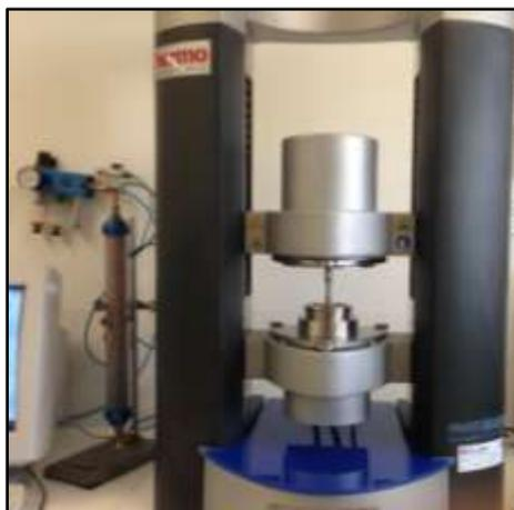
**Figura 10.** Reómetro de tensão controlada MARS III (Haake, Alemanha).
