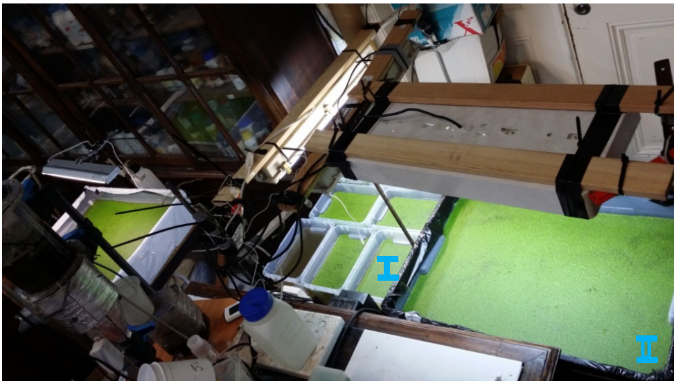
Figura 3. 6 – Estrutura de iluminação, vista superior, do teste de depuração (I) e do crescimento de biomassa para alimentação do digestor (II).
