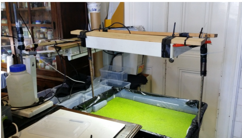
Figura 3. 4 - Montagem da estrutura de iluminação e preparação do teste de depuração do chorume pela Lemna minor .
