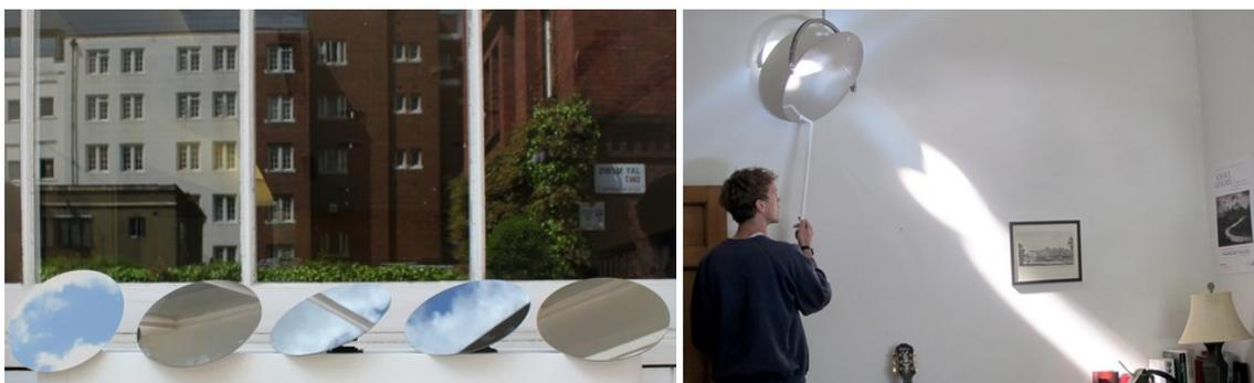
fig 33 - Projecto Sun Sill, pequenos heliostatos aproveitam a luz natural para *task lighting*.
