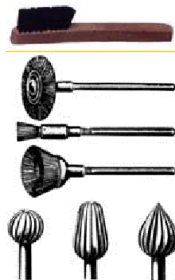
Figura 244 - Instrumentos de limpeza agressivos: Escovas metálicas, escovas rotativas e fresas abrasivas [Branco, Fernando; Brito, Jorge (2010)]
