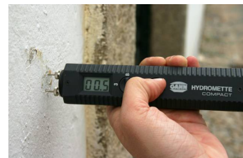
Figura 387 – Medição de humidade com humidímetro [LEB (2008)]
