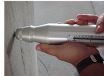
Figura 93 - Ensaio esclerométrico [ http://www.oz-diagnostico.pt/fichas ]
