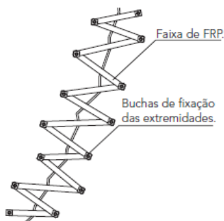
Figura 271 e 272 – Faixas de FRP aplicadas em reparação de fenda [Cóias, Vítor (2007)]
