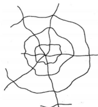
Figura 231 – Fissuras em teia de aranha [Argilés, Josep M. et al (1999c)]
