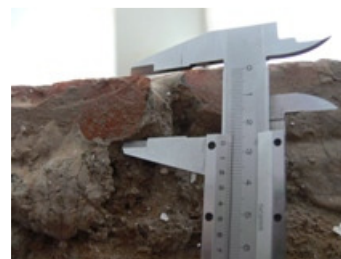
Figura 83 – Medição da espessura de elemento cerâmico do pavimento com uma craveira, Convento das Maltezas, Estremoz [Foto do autor]
