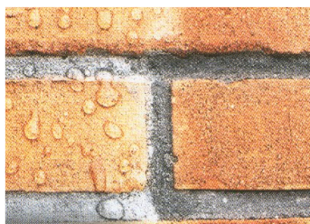
Figura 258 - Efeito da aplicação de um líquido hidrófugo [Flores, Inês; Brito, Jorge (2004b)]
