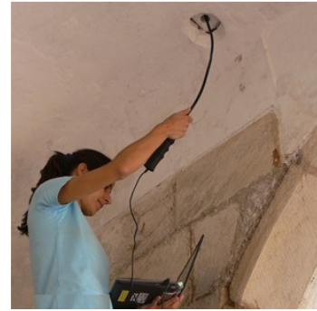
Figura 355 - Observação buroscópica de cavidades em abóbada [LEB (2010a)]
