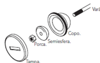
Figura 291 - Sistema de rótula constituído por semi-esfera e copo, permitindo a adaptação da fixação a qualquer inclinação do confinador [Cóias, Vítor (2007)]
