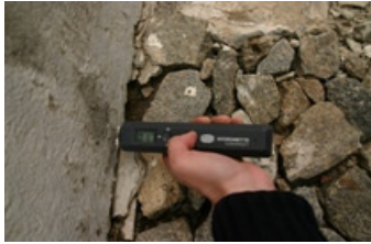
Figura 94 – Medição da humidade superficial, Ex Celeiros EPAC, Évora [Foto LEB]
