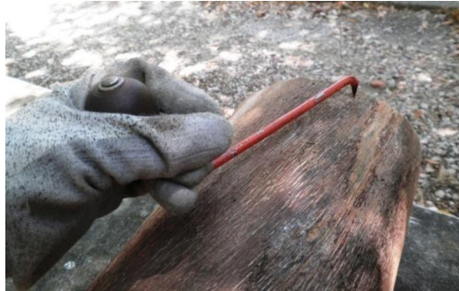
Figura 15 - Medição do fio espiralado de um toro de 6 anos com um riscador para fio.
