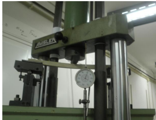
Figura 19 - Ensaio à flexão estática de um provete de 4 anos.
