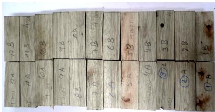
Figura 14 - Provetes de 4 anos com 6 cm de altura prontos a serem comprimidos.
