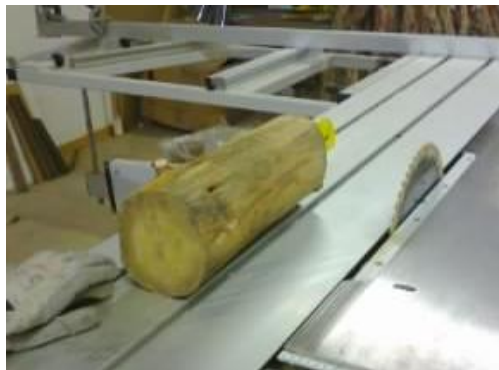
Figura 9 - Serração dos troncos de E. botryoides .
