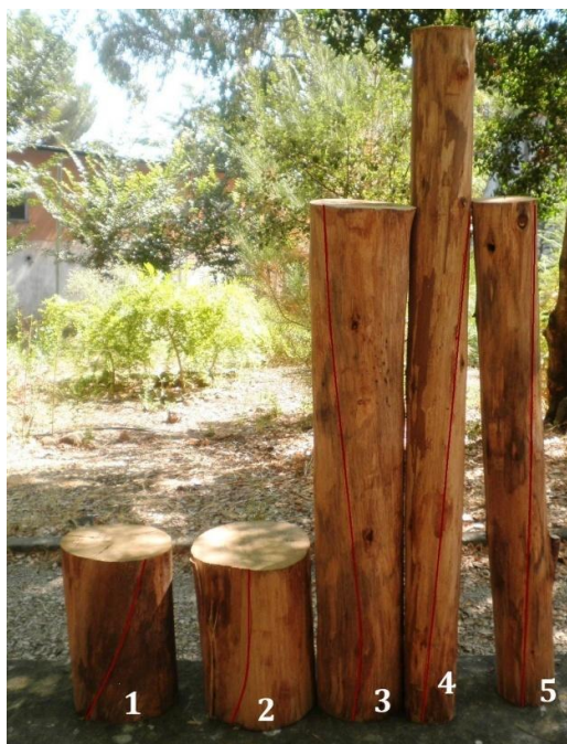
Figura 23 - Toros de E. botryoides com 6 anos de idade com o fio espiralado marcado a vermelho.
