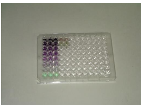
Figura 7 - Placa com resultado de técnica de quantificação de proteína de Bradford modificada. (Fotografia do autor)
