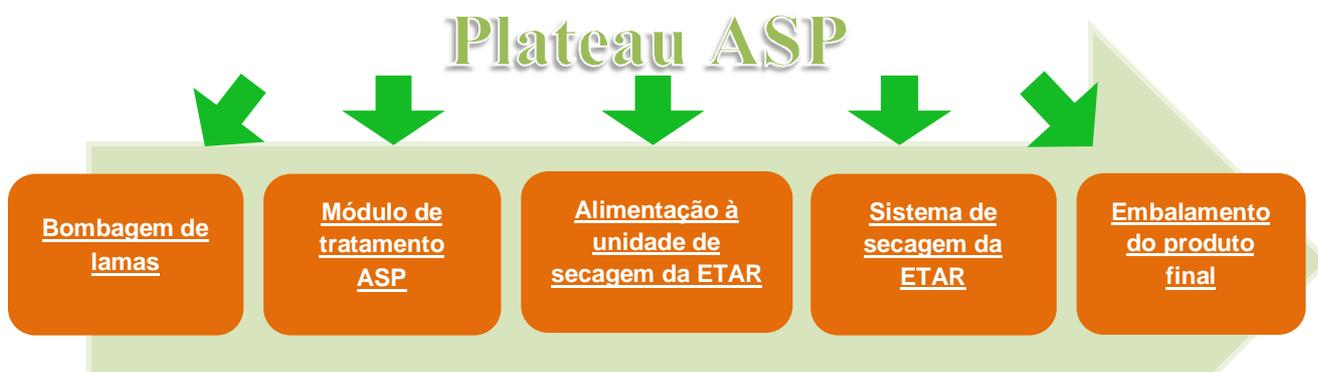
**Figura 4-8 Diagrama da incorporação da solução Plateau ASP no layout da ETAR da Guia**
