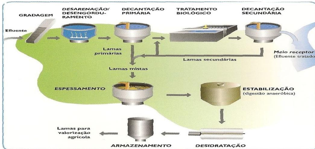
Figura 3-1 Esquema de funcionamento de uma ETAR (Adaptado de Dias, 2004)
