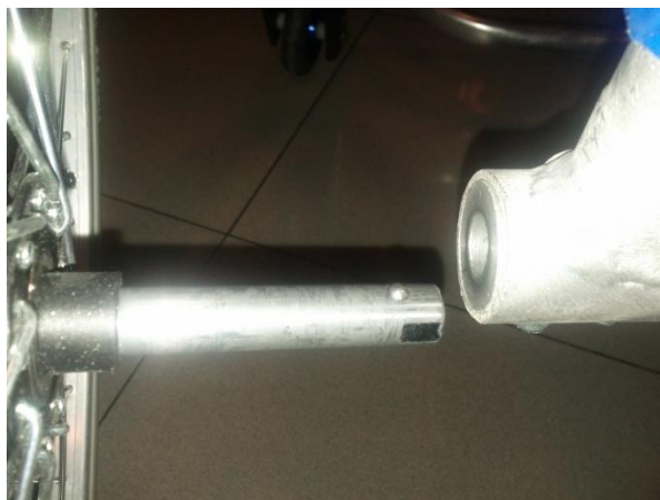
Imagem 5. Sistema de extracção rápida das rodas de tracção
