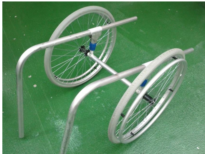
Imagem 7. Estrutura principal da cadeira de rodas sem cortes
