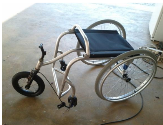
Imagem 16. Protótipo com a aplicação da roda dianteira direccionável em fase de construção
