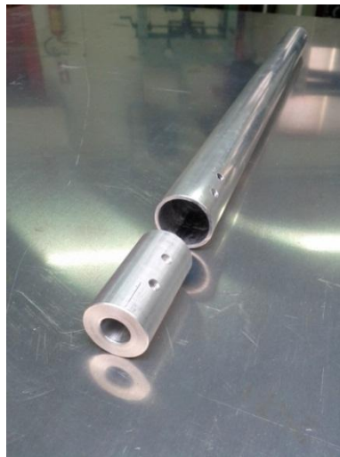
Imagem 4. Sistema de camber e de fixação das rodas de tracção
