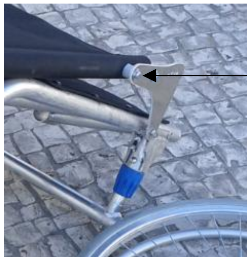
Imagem 13. Pormenor do sistema de fixação das costas
