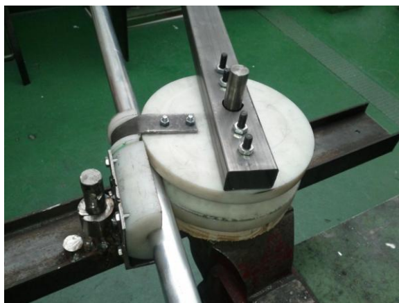
Imagem 2. Máquina de dobrar tubo antes da operação de dobragem
