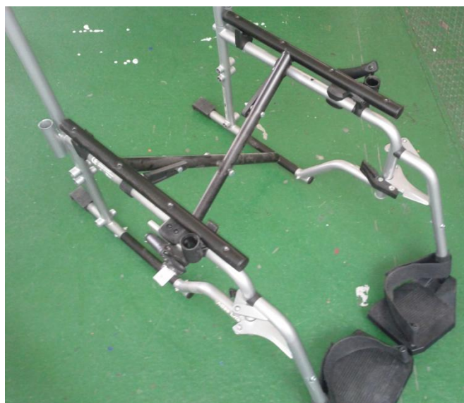
Imagem 1. Estrutura de uma Invacare atlas lite com apoios de pés
