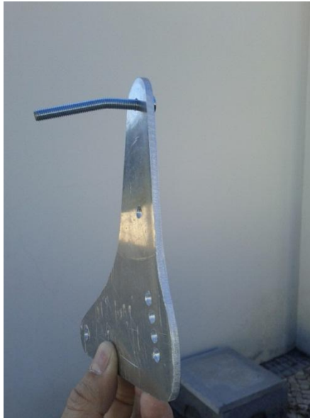
Imagem 12. Deformação do parafuso de fixação das costas por queda
