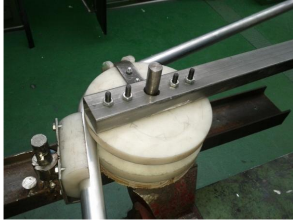
Imagem 3. Máquina de dobrar tubo após operação de dobragem
