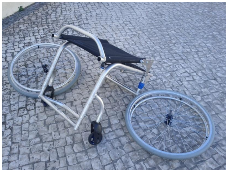
Imagem 15. Protótipo de modelo rígido de cadeira de rodas sem as rodas e com o encosto rebatido
