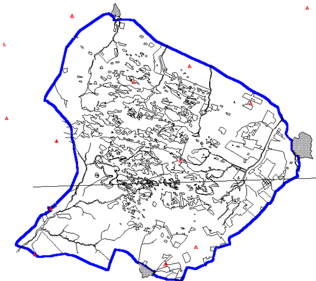
Figura 18 - Aspecto da união das duas fotografias através da transformação de coordenadas. A linha horizontal representa o limite das áreas úteis das fotografias, na zona de sobreposição.
