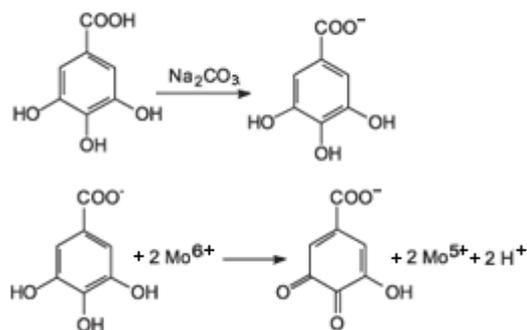
**Figura 7 - Reacção do Ácido Gálico com Molibdénio, componente do reagente de Folin-Ciocalteu** (Fonte: [http://www.scielo.br/scielo.php?pid=S0100-40422009000300013&script=sci\\_arttext](http://www.scielo.br/scielo.php?pid=S0100-40422009000300013&script=sci_arttext))
