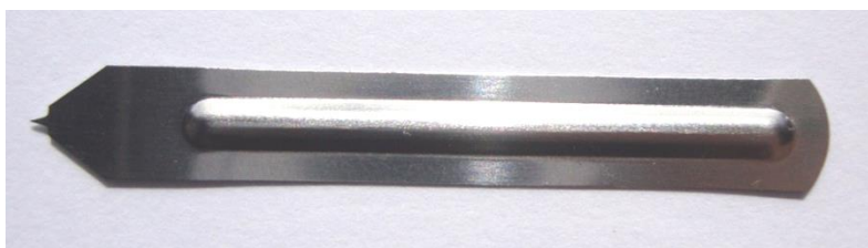
Figura 12 - Lanceta metálica com ponta de 1 mm de penetração da ALK-Abelló® (fotografia original).
