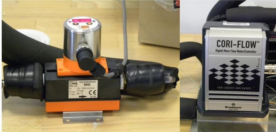
Figura C.4. Caudalímetro magnético para el circuito de agua (i) y Coriolis para el circuito de refrigeración (d).
