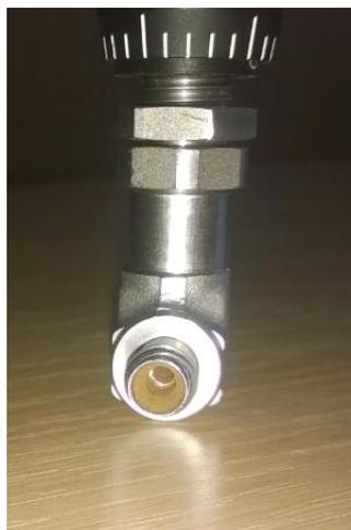
Figura A.2. Oxidación en la entrada de la válvula de expansión inicial.
