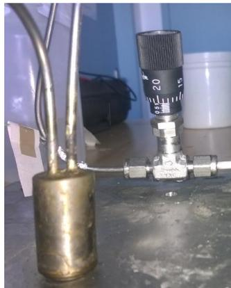
*Figura C.2. Depósito RL (i) y válvula de expansión (d).*
