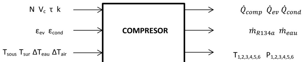
*Figura III.6. Diagrama entrada-salida del compresor.*
