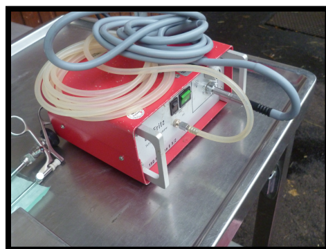
Legenda: tubo azul – cabo de fibra óptica; tubo branco – cabo para insuflação
