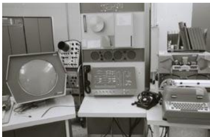
Fig. 128 - Computador PDP-1, o primeiro "minicomputer"(1960) (Carlson 2003, section 1 ).
