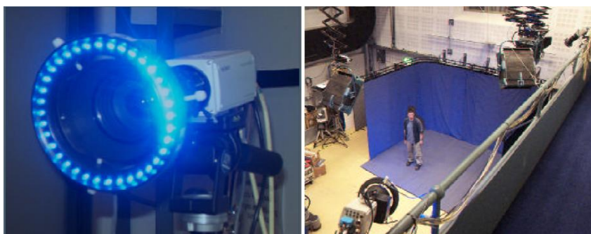
Fig. 159a/159b - Estúdio virtual com tecido retro-reflector e câmara equipada com um anel de LED's. A luz emitida pelo anel luminoso possibilita a obtenção de uma boa imagem da acção em estúdio por contraste com o tecido retro-reflector Truematte (Grau 2002).
