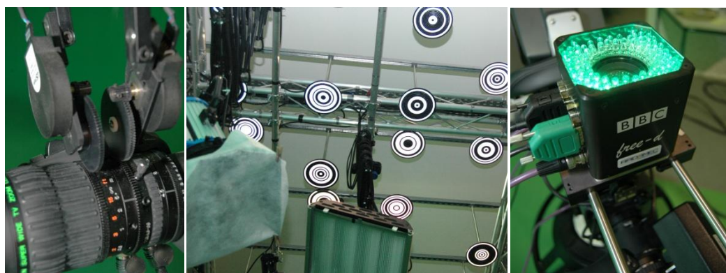
Fig. 86a/86b/86c – Sistema de tracking instalado no estúdio virtual da ESCS onde dois tipos de tracking são utilizados: a) tracking por sensor mecânico; b) e c) o sistema free-d (ver Capítulo II, secção 2.3.4) (fotografias disponibilizadas por Miguel Baptista da ESCS).
