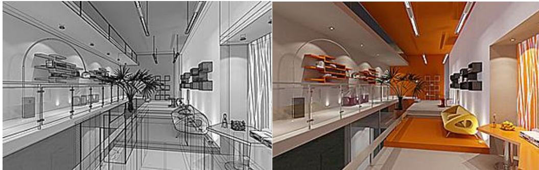
Fig. 73a/73b – a) modelo tridimensional em wireframe com sombreamento; b) imagem gerada depois da aplicação de materiais e configuração do layout da cena do modelo representado em a) (Archinteriors Vol. 2. © 2000-2010 Trinity Animation Inc).
