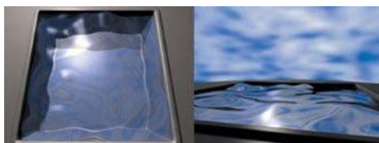
Fig. 256 - Efeito de Fresnel – ao olhar directamente para baixo numa piscina observam-se menos reflexos do que se se olhar a partir de um ângulo mais afastado (Valinho et al. 2007).
