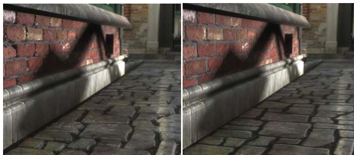
Fig. 80a/80b - Na imagem à esq. muro e passeio foram renderizados com parallax mapping , à dir. com bump mapping . O método de Dynamic Parallax Occlusion Mapping with soft shadows permite ainda utilizar mapeamento de sombras nas superfícies e gerar dinamicamente reflexos dos objectos na cena (Tatarchuk 2006a).
