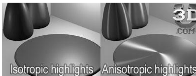
Fig. 216 - A aplicação de shaders diferentes na superfície do objecto pode conduzir a resultados completamente diferentes; na imagem da esquerda o material parece suave e aveludado enquanto na imagem da direita o material tem uma aparência fria e metálica (3dRender.com, 2001).
