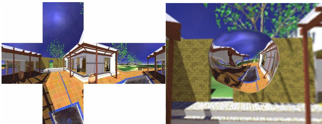
Fig. 270a/270b - Apesar de não ser uma representação fisicamente correcta, em superfícies muito curvas dão uma boa ilusão de superfície reflectora com um custo computacional bastante inferior ao do ray tracing (Pohl 2008 & NVIDIA developer zone , 2004)
