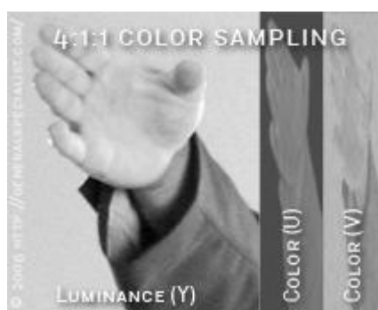
Fig. 168 - Informação recolhida por uma amostra de cor captada a 4:1:1 (Hummelstrand 2006).
