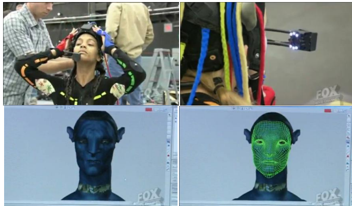
Fig. 123a/123b/123c/123d - Sistema de captação da expressão facial com capacete personalizado e uma câmara de filmar incorporada; os elementos recolhidos são transformados em informação 3D por software apropriado.
