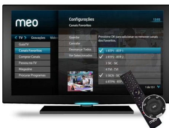
Fig. 158 – Fornecedores de Televisão por cabo ou por satélite instalam plataformas controladas por telecomandos que permitem aos espectadores: gravar; parar emissões em directo; retomar a visualização noutra altura; consultar a programação dos diferentes canais entre outras funcionalidades (meo-Funcionalidades, PT © 2010).
