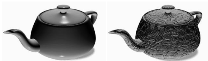
Fig. 233a/233b - Modelo antes e depois de aplicado o efeito de bump mapping (rugosidade) ( Answers.com , © 2010 Answers Corporation).
