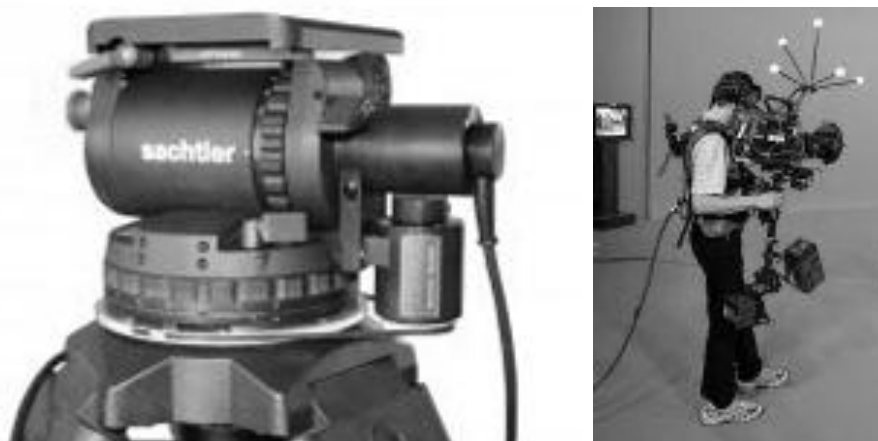
Fig. 61a/61b - Sistemas de tracking da THOMA: Sensor-Kit Vídeo 25 (15 minutos para a sua adaptação a um tripé convencional) e o THOMA Walkfinder (sistema por infra-vermelhos) com a capacidade de funcionar num estúdio com 120 m 2 nos 360° e com delay de apenas uma frame , sem necessidade de recalibração durante a produção ( Thoma - dedicated to accuracy , n.d.).
