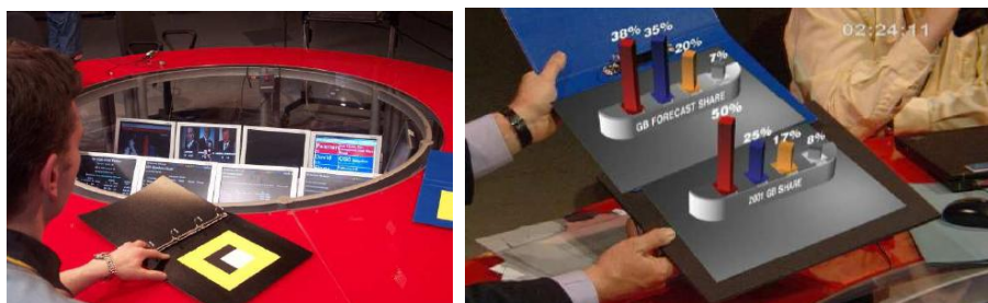
Fig. 177a/177b - À direita marcadores rectangulares servem para que o apresentador se possa orientar no manuseamento daquilo que serão gráficos 3D na imagem compósita final. Este processo exige sempre um ensaio prévio (Thomas 2007a).
