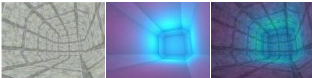
Fig. 82a/82b/82c - Este modelo foi concebido com uma malha de 77 vértices e 44 faces ao qual foram aplicados dois mapas, o 1º de textura a) e o 2º de iluminação b), a 3º imagem c), mostra o resultado da aplicação do lightmap (Miller 1999).
