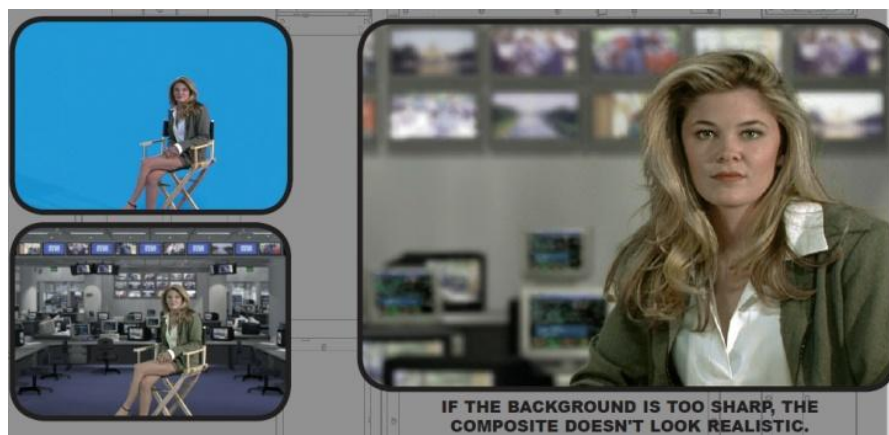
Fig. 171 - Imagem ilustrativa do software disponibilizado pela Ultimatte para aplicação do efeito de desfocado ao fundo tornando assim a imagem composta mais realista ( Ultimatte Corporation , © 2010 Ultimatte Corporation ).
