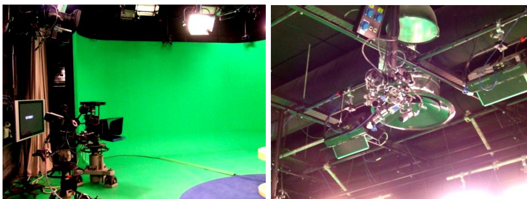
Fig. 52a/52b - Estúdio Virtual da RTP em Lisboa, equipado com um sistema de Cenografia Virtual da Orad. À dir. podemos ver suspensas na grelha superior do estúdio, câmaras especiais que procedem à monitorização da posição das câmaras de realização (fotografias realizadas por Paulo Gonçalves, 2008).
