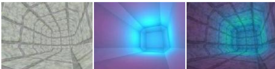
Fig. 265a/265b/265c - Este modelo foi concebido com uma malha de 77 vértices e 44 faces ao qual foram aplicados dois mapas, o 1º de textura e o 2º de iluminação, a 3º imagem mostra o resultado da aplicação do lightmap (Miller 1999).
