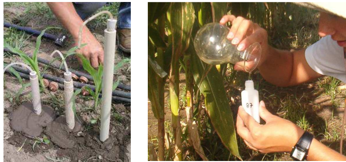
Figura 3.7 Cápsulas porosas utilizadas nos ensaios experimentais (são impostas sucções no interior das cápsulas de modo a retirar água do solo)
