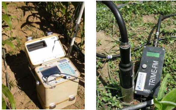
Figura 3.6 Equipamentos TDR utilizados. À esquerda a unidade de leitura ligada ao fios dos sensores enterrados em Alvalade e à direita a sonda no tubo de acesso na Mitra.
