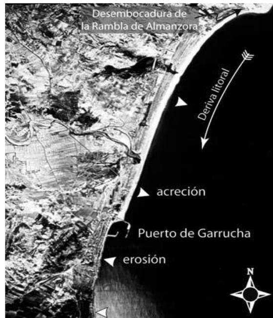
Esta imagen muestra agresión que ha producido la construcción del puerto Garrucha (Almería) en la zona litoral y en la distribución de zonas de acreción y erosión como señala la imagen.
