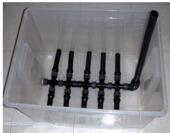
Figura 6 – Fotografia do sistema de drenagem, colocado no fundo da caixa
