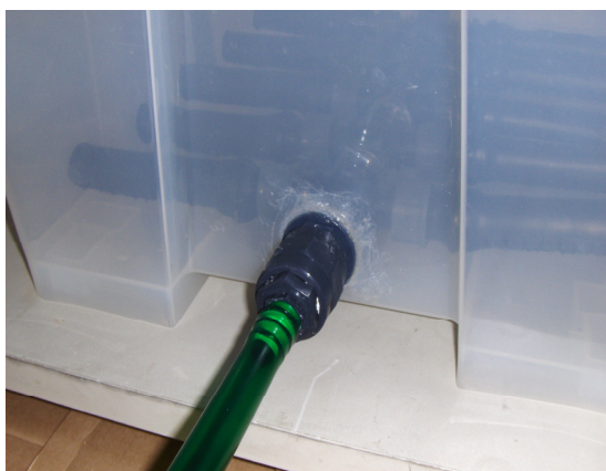
Figura 5 – Fotografia mostrando a união da mangueira ao “passa paredes”.
