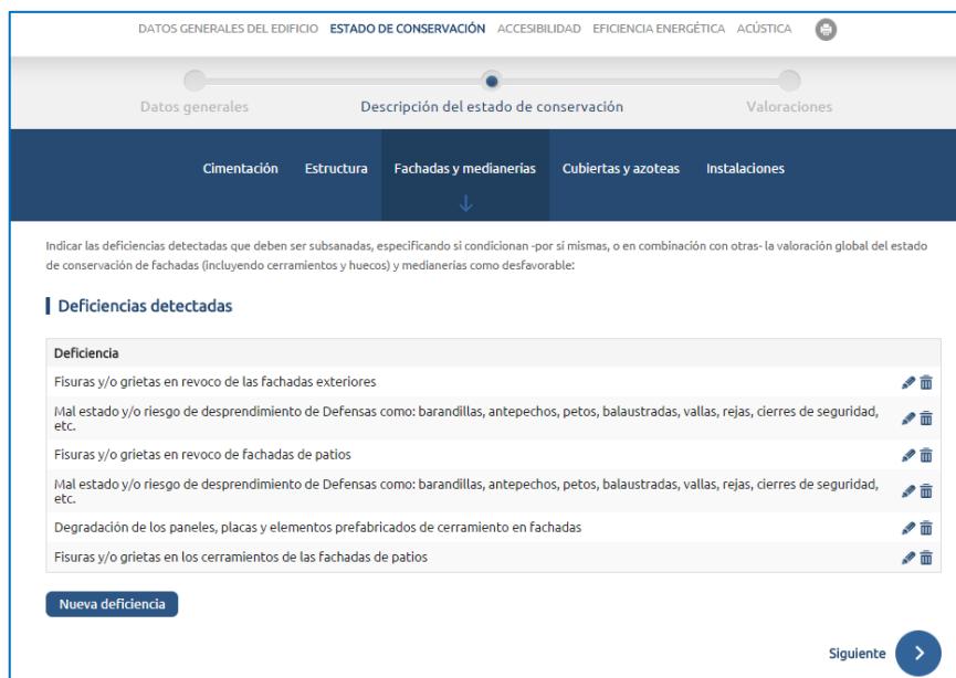
Ilustración 51. Deficiencias de fachadas y medianerías [Anexo III. IEE]
