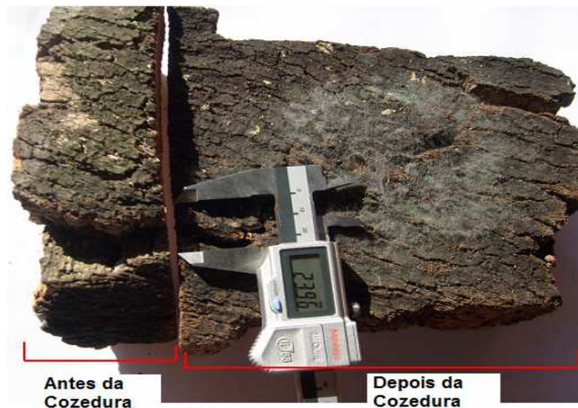
Figura 10 : Após a cozedura, as fendas podem reduzir sensivelmente a sua largura devido ao endireitamento da cortiça.
