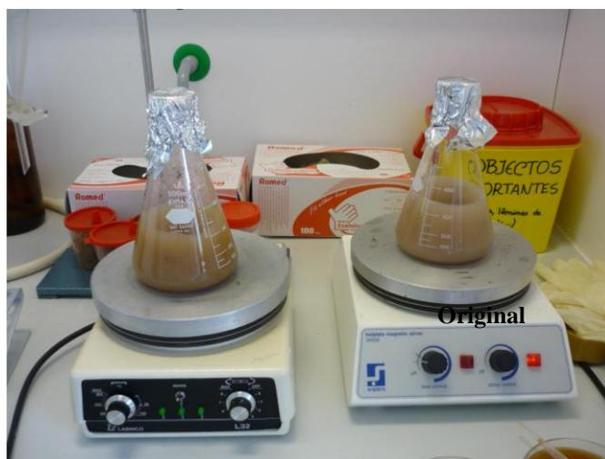
**Fig.12:** Erlenmeyer de 500 ml com a solução: água, pepsina, ácido clorídrico e amostra de músculo triturado, sobre o agitador magnético.
