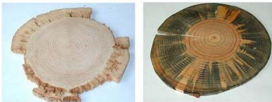
Figura 4. Exemplos de durabilidade do cerne em comparação com o borne: borne de uma rodela de criptoméria ( Cryptomeria japonica ) severamente atacada e destruída pela podridão castanha cúbica ( Coniophora spp.) (esquerda) e rodela de pinheiro bravo ( Pinus pinaster ) atacada pelo fungo do azulado da madeira ( Ceratocystis spp.)
