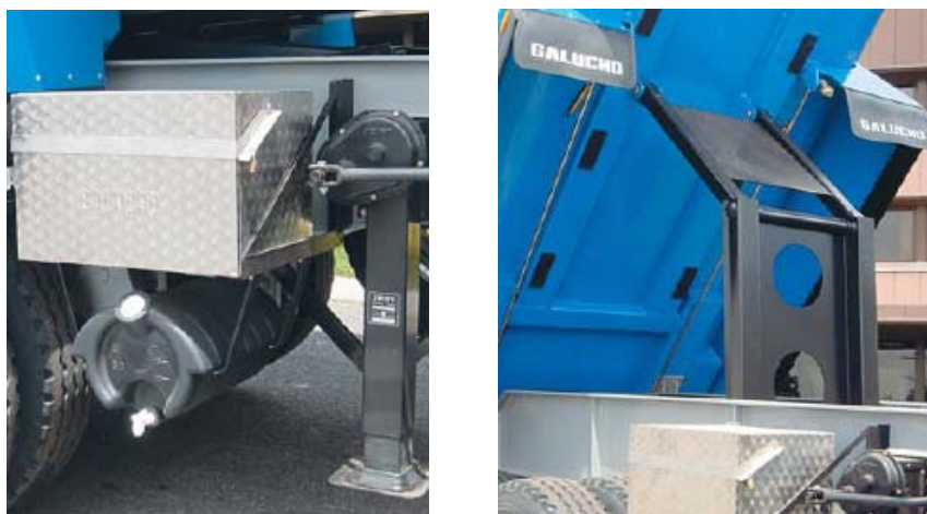
Figura 47. Sapatas de apoio e estabilizador.
