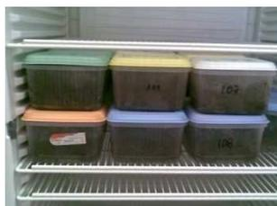
**Figura 3.5** – Visão geral de ensaio de mineralização do azoto segundo uma incubação aeróbia sem lixiviação.
