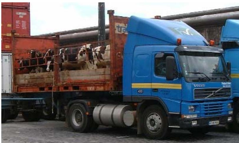
Figura 7 – Veículo com contentor de transporte de bovinos por via marítima (Afonso, M.).
