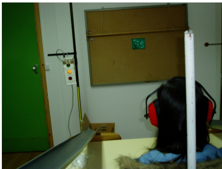
Figura 7. Aspecto do dispositivo do Teste de velocidade de reacção visual periférica simples (TVRVPS), à esquerda. Ao fundo, vê-se a marca que o sujeito deveria fixar fovealmente para, periféricamente, captar a iluminação da luz amarela que se vê acesa à esquerda, a qual foi accionada pelo investigador com ajuda do sensor de pressão de uma das calhas.
