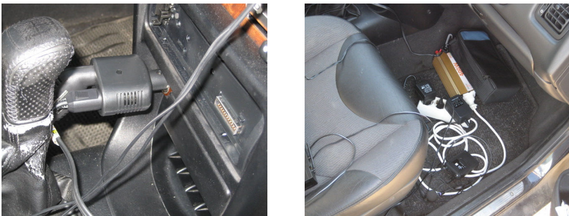
Figura 26. Sistema de dupla ligação ao isqueiro do carro (esquerda) e aspecto parcial do conversor 12/220 v e ligações do computador portátil, do amplificador de microfone sem fios e das caixas geradoras de impulso eléctrico para os LED's (direita).
