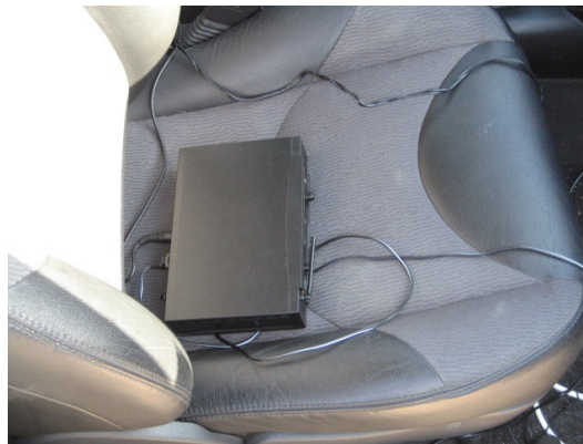
Figura 24. Dentro do carro, no lugar do pendura, amplificador do microfone sem fios, com as ligações para o microfone, alimentador do amplificador e ligação ao Biopac
