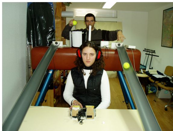
Figura 6. Aspecto do dispositivo do teste TVRVPC, vendo-se uma bola a rolar numa das duas calhas, tendo sido largada após deixar de estar pressionada contra o sensor de pressão. O sujeito, com os headphones colocados para não se aperceber do rolar da bola da calha, aguarda que a mesma entre no seu campo de visão para pressionar outro sensor de pressão.
