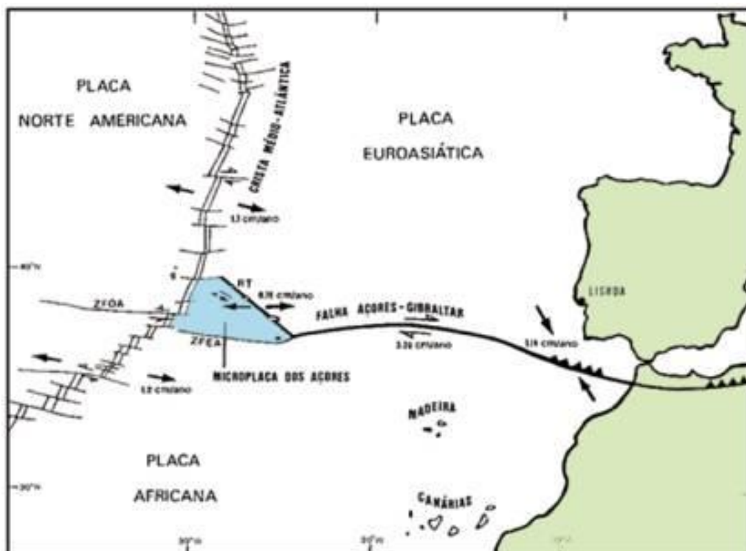
Figura 9. Imagem do Enquadramento geotectónico do arquipélago dos Açores. Fonte: http://www.jcnunes.uac.pt/Tese/capitulos/1.htm .
