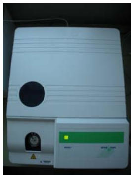
Figura 4.1: Equipo de calorimetría diferencial de barrido.
