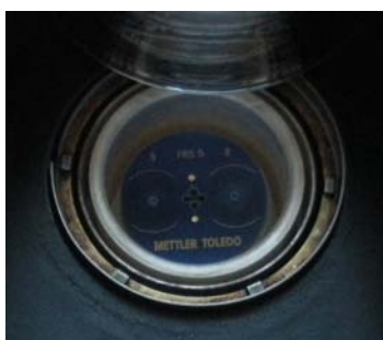
Figura 4.2: Horno del equipo DSC.
