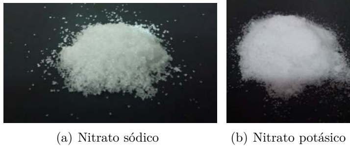
Figura 3.1: Componentes de la Sal Solar.
