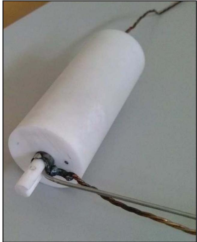
Ilustración 75 - Vasija con calentador y varilla interior
