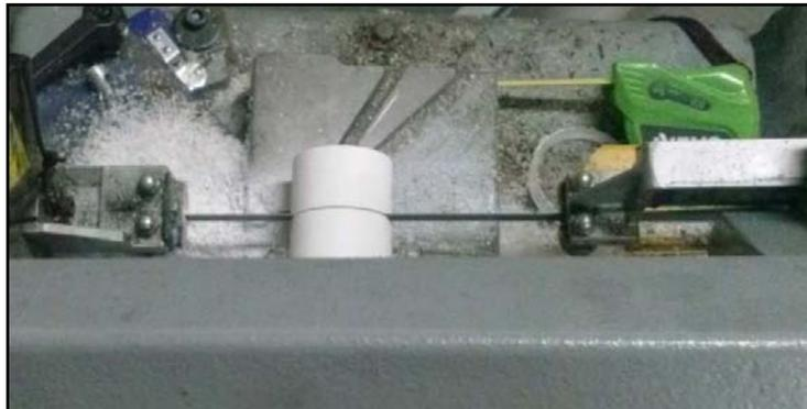
Ilustración 65 - Imagen de la tronadora cortando la barra
