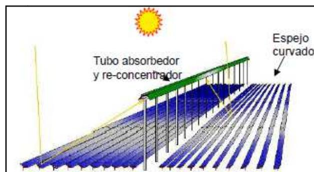
Ilustración 4 - Concentradores lineales, tipo fresnel
