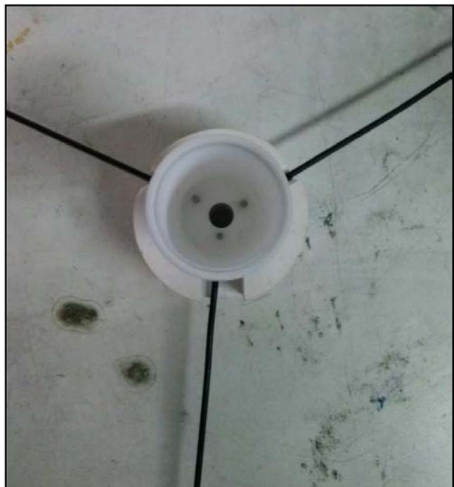
Ilustración 77 - Vasija, con la base y termopares
