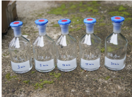
Figura 15 - Garrafas não reativas do tipo Winkler, numeradas com os respectivos tempos de medição.
