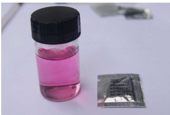
Figura 16 - Reagente DPD adicionado numa amostra de água.
