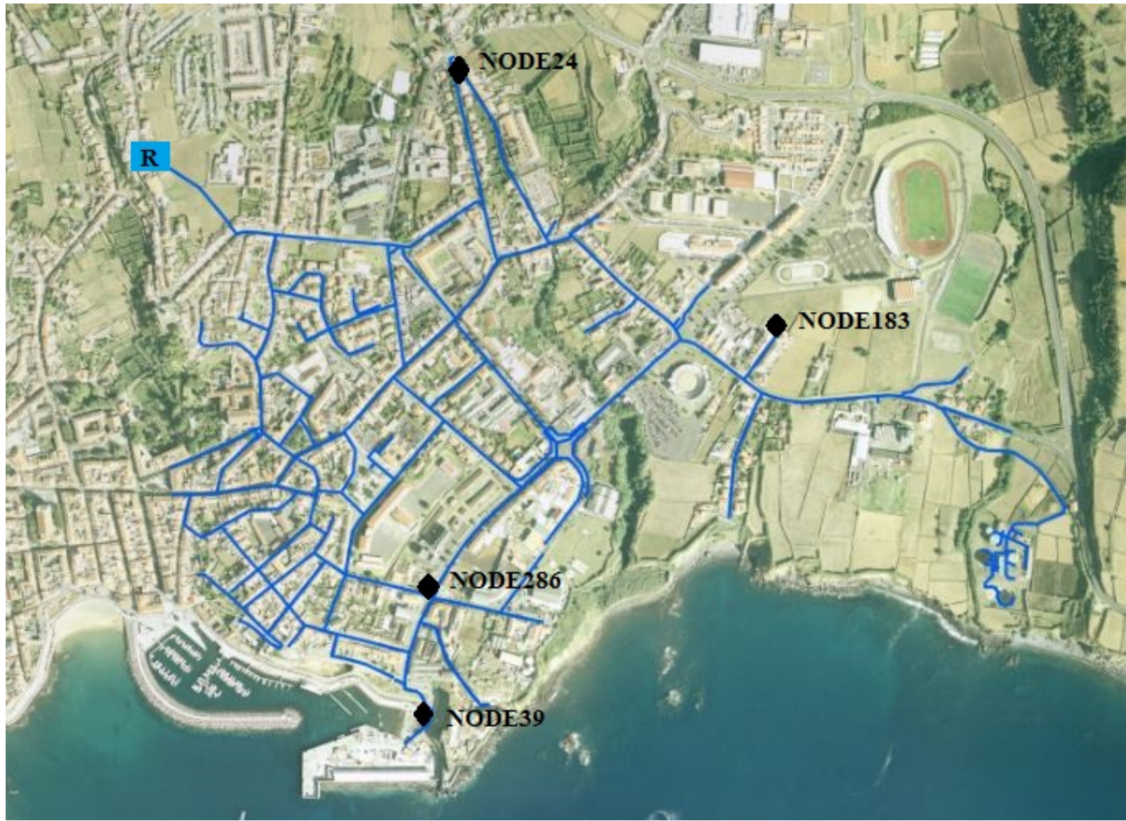
Figura IX: Mapa da rede de distribuição do caso de estudo (azul) com a representação dos pontos de medição da pressão (preto) e reservatório (R).
