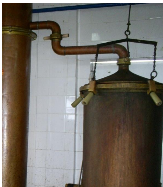
Fig.31 – Capacete e braço do alambique de coluna. Piedade
