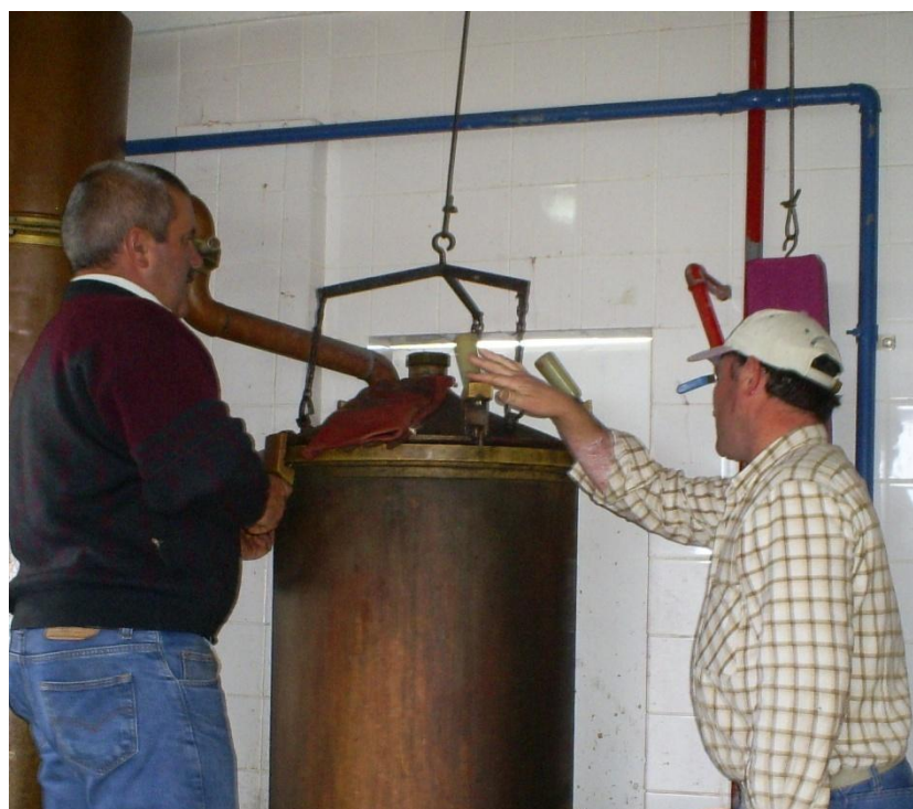
Fig.32 – Pinças do capacete do alambique de coluna. Piedade
