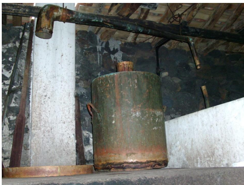
Fig.36 – Capacete do alambique de caldeira. Núcleo Museológico do Lajido.
