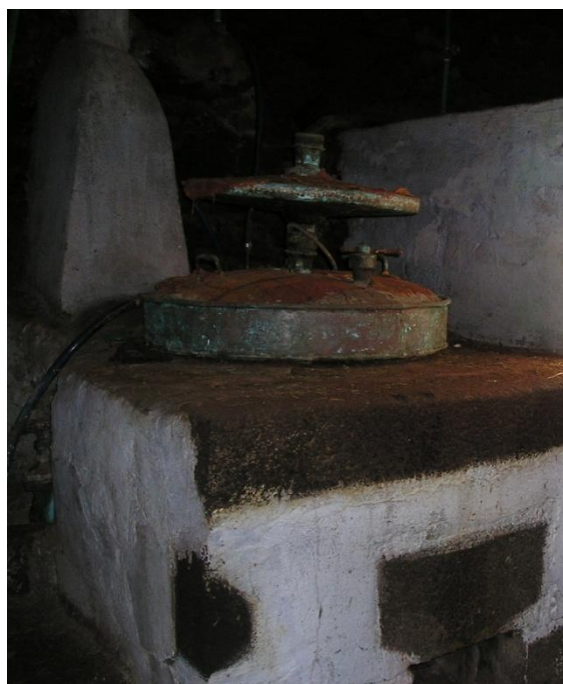
Fig.29 – Alambique com lentilha (pratos).
