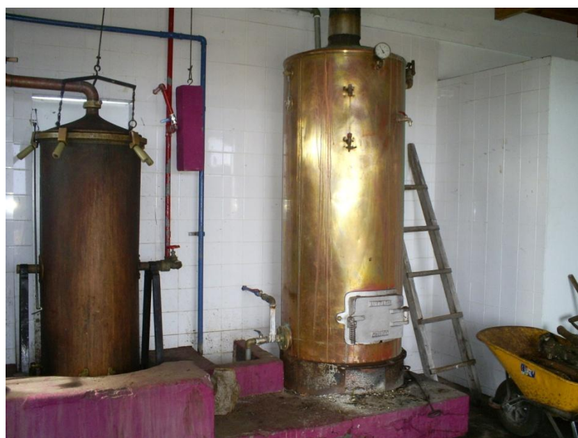
Fig.30 – Alambique de coluna de destilação contínua. Piedade
