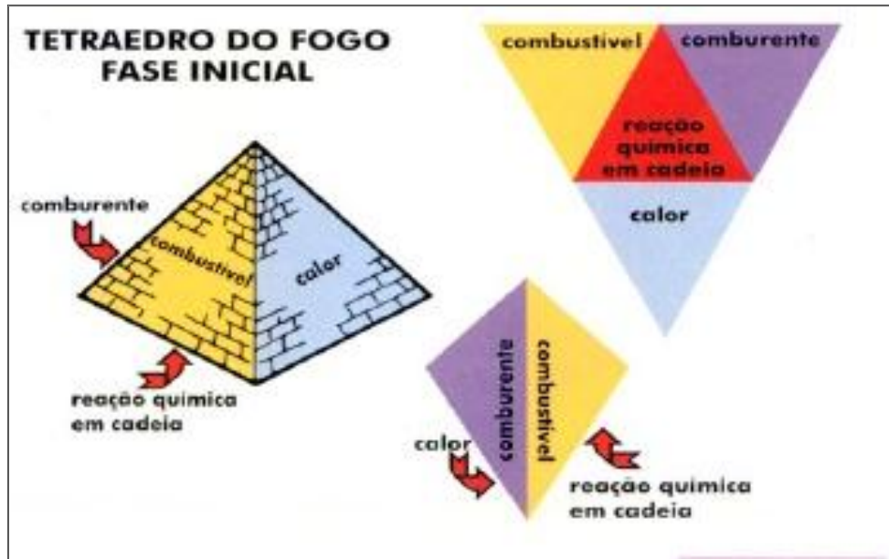
Figura 1 - Tetraedro do fogo (Manual de Fundamentos do Corpo de Bombeiros -2006)
