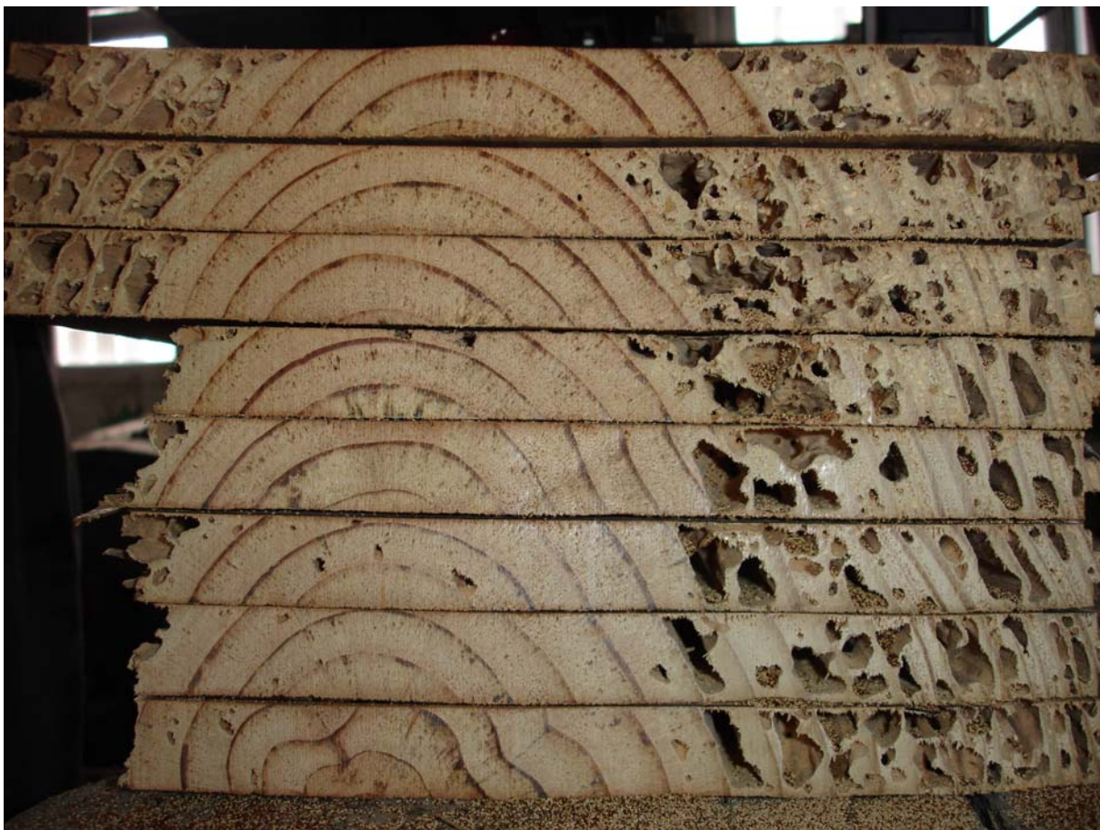
Figura 3. Consumo do borne da madeira pela Criptotermes brevis .
