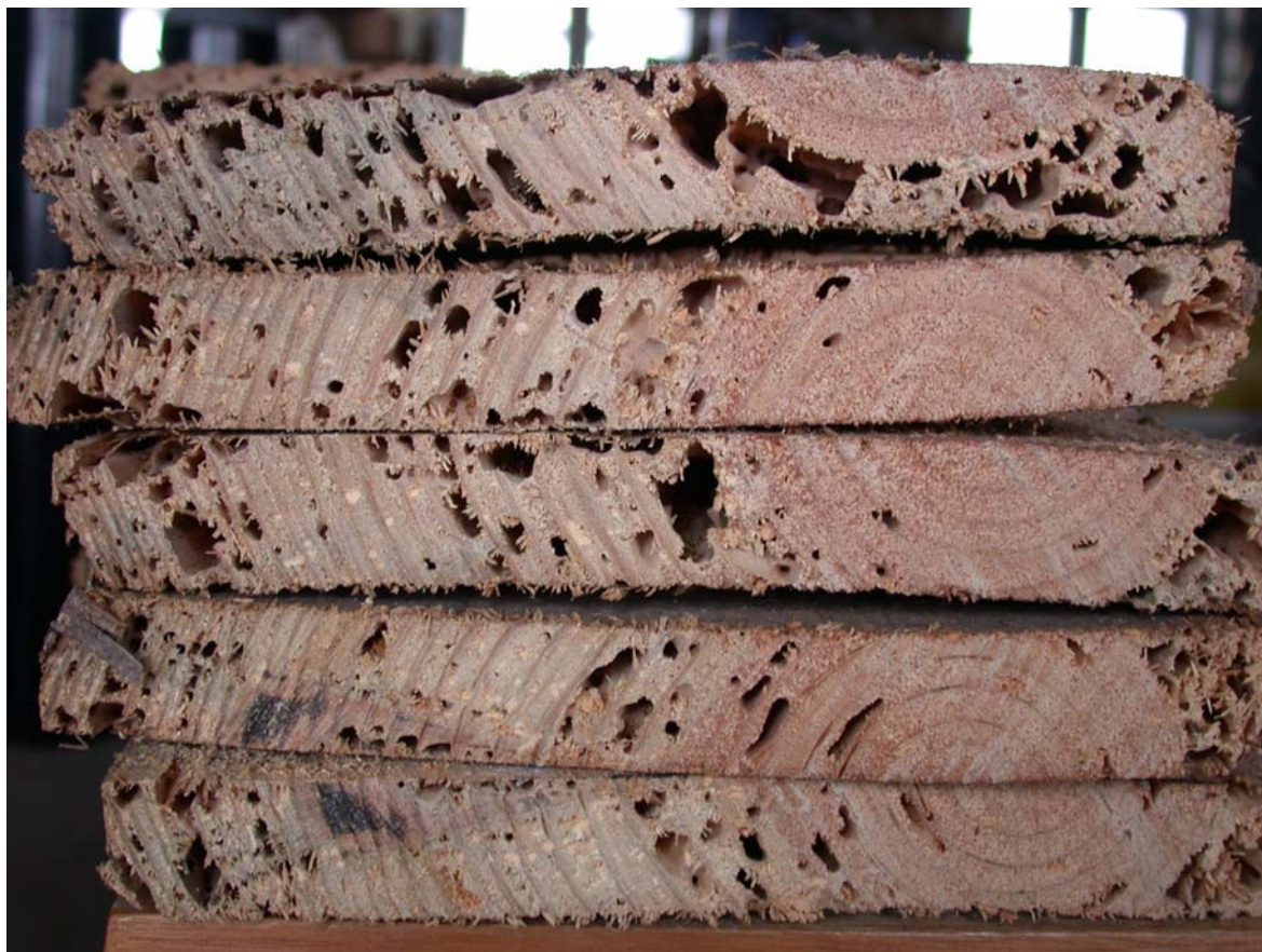
Figura 8. Estragos provocados por Cryptoterme brevis , mostrando pouca apetência pelo cerne.
