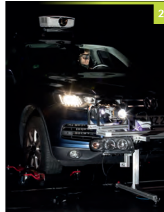
Abbildung 2 Untersuchung des Einflusses der Beleuchtung auf die kamera-basierte Objekterkennung in realen Feldbedingungen Quelle: Institut für Produktentwicklung und Gerätebau
