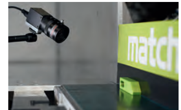
Identifikation der Bauteilorientierung in einer Zuführanlage mithilfe digitaler Bildverarbeitung und künstlicher neuronaler Netze. Foto: match
