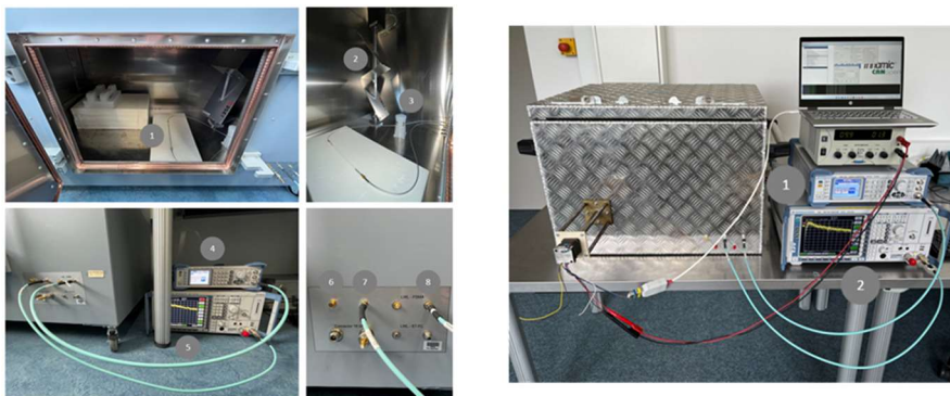
Abbildung 5: Messungen in der Teseq Kammer (links) [1: DUT, 2: Modenrührer, 3: TX Antenne, 4: Signalgenerator, 5: Messempfänger, 6: Abschlusswiderstand DUT, 7 & 8: Anschluss DUT & TX Antenne] und der kleinen Kammer (rechts) [1: Signalgenerator, 2: Messempfänger].
