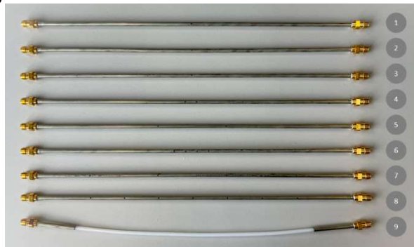
Abbildung 3: Musterprüflinge aus UT-141-SATP-M17 Kabel mit einer ( 1-3 ), zwei ( 4-5 ), vier ( 6-7 ) bzw. sieben ( 8 ) Koppelzonen und ungeschirmter Referenzleitung 9 .
