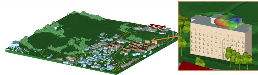
Abbildung 4: Vollständiges Modell aus Kapitel 3 mit einem Sektor einer 5G-Mobilfunkbasisstation auf einem Gebäude (s. Detailausschnitt).
