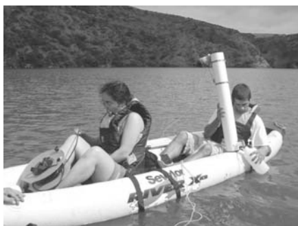
Figura 3 - Amostragem da coluna de água nos lagos, ao longo de um perfil vertical, na zona de maior profundidade (amostragem da Lagoa Funda).
