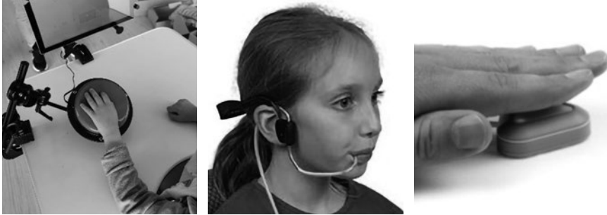
Figura 4 — Exemplo de soluções comercialmente disponíveis, manípulo de pressão (Big Red Switch – Ablenet), Sip e Puff Orion, manípulo de proximidade (Candy Corn - Ablenet)
