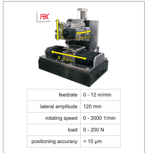
Fig. 3 CNC-tribometer
