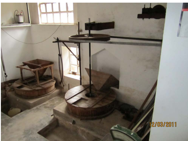
Figura 12. Sala de maquinaria: muelas
