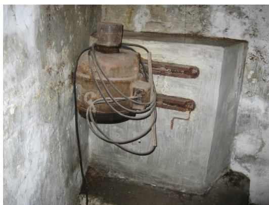
Figura 30 – Motor elétrico que foi instalado no moinho da Ladeira de São Francisco, n. os 2 e 4, Nossa Senhora da Conceição. Fotografia do autor. Ano de 2012.
