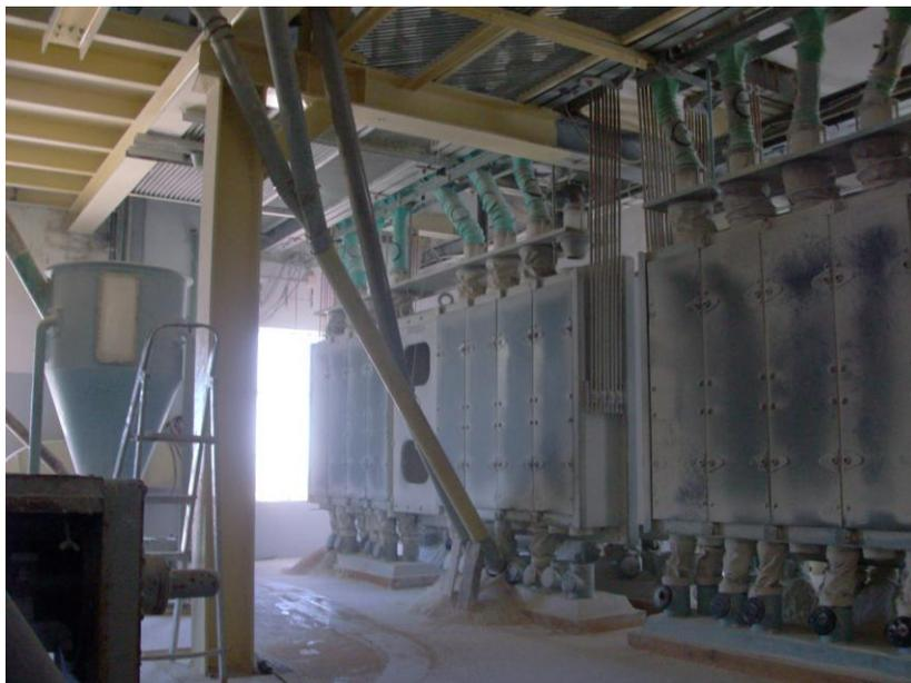
Foto 72 – Duas plansichters (adquiridas à Sociedade Industrial Aliança) situadas no 2º piso; as plansichters peneiram a farinha a partir do processamento dos moinhos de cilindros, situados no piso inferior, Agosto 2010 (Autora: Conceição Toscano)
