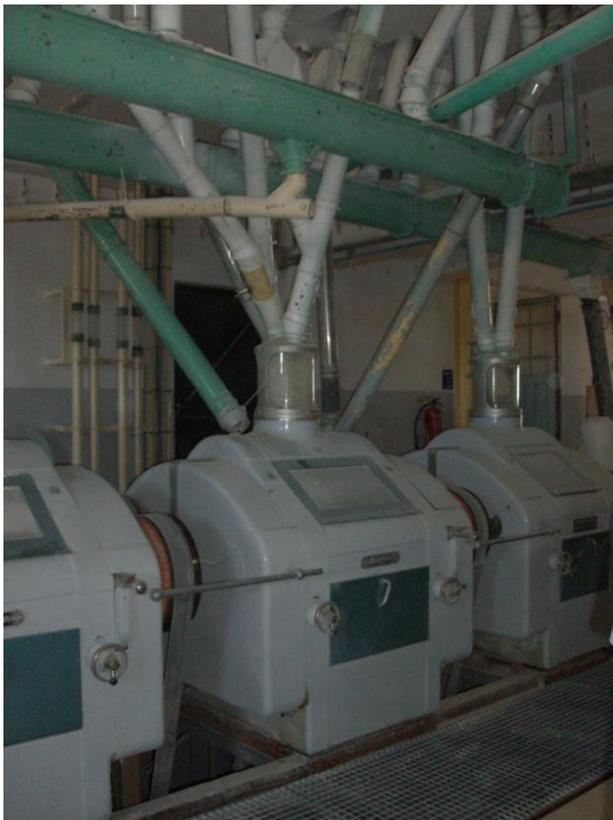
Foto 71 – Outra perspectiva dos moinhos de cilindros, mostrando a sua disposição e as tubagens de alimentação e aspiração; a última das máquinas é o único moinho de cilindros anteriormente da Aliança, datando dos anos quarenta e da marca Daverio S.A., Agosto 2010 (Autora: Conceição Toscano)
