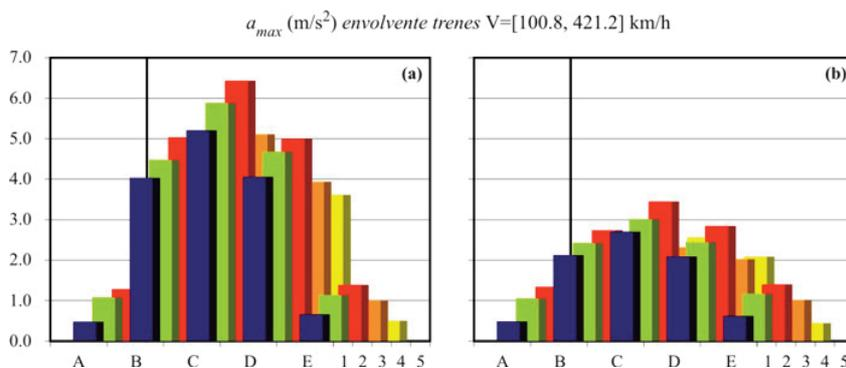
Figura 9. Envolturas de aceleración máxima en puente Arroyo Bracea II antes y después del reacondicionamiento
