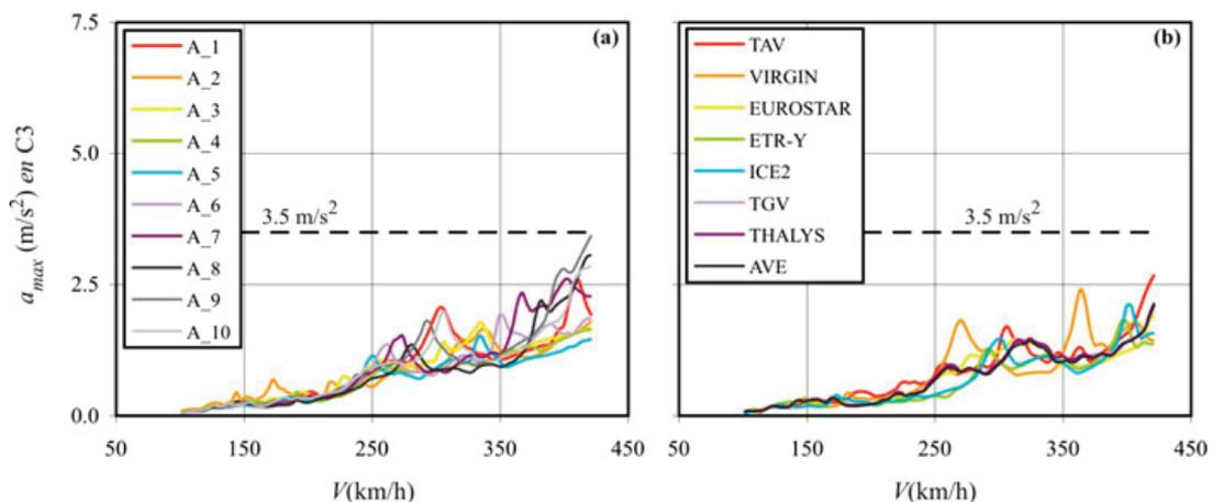
Figura 10. Aceleración vertical máxima en el punto C3 ante la circulación de (a) los trenes HSLM-A y (b) composiciones reales en el caso reacondicionado
