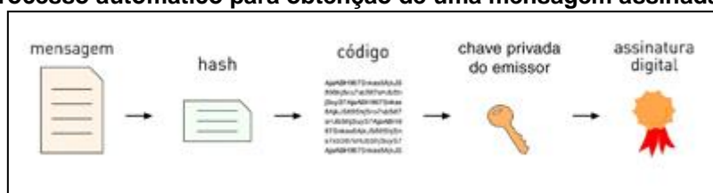
Figura 15: Processo automático para obtenção de uma mensagem assinada digitalmente
