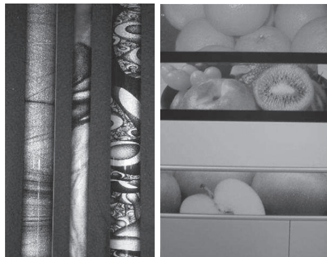
Figura 15. Placas cerâmicas decoradas por impressão por jato de tinta com tintas orgânicas (ITC).
