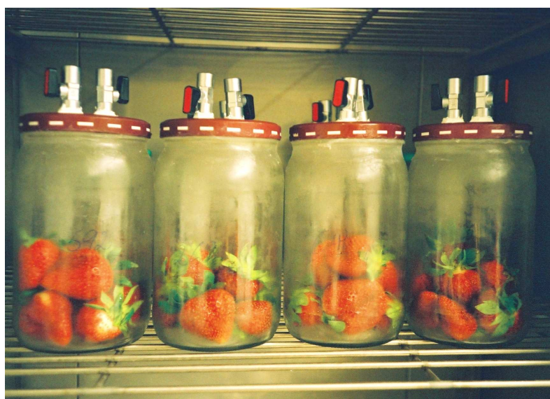
Figura 23: Frascos para a medição de taxas respiratórias colocados dentro da câmara de armazenamento.
