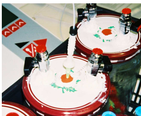
Figura 24: Medição da concentração em oxigénio e dióxido de carbono em sistema fechado.
