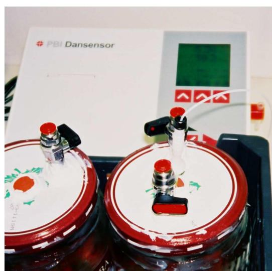
Figura 24: Medição da concentração em oxigénio e dióxido de carbono em sistema fechado.
