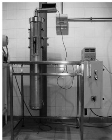
Figura 4 Equipo para la medición del estado pulverulento de materiales a granel por el método de caída continua. Esquema de las partes de las que se compone el equipo de ensayo.
