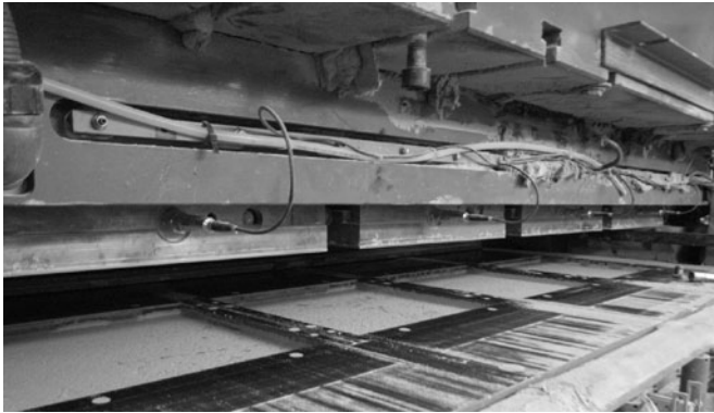
Figura 5. Punzones isostáticos dotados de transductores de presión en un molde de 4 salidas de 330 mm x 330 mm de formato nominal equipado con el sistema ISOPRESS®.
