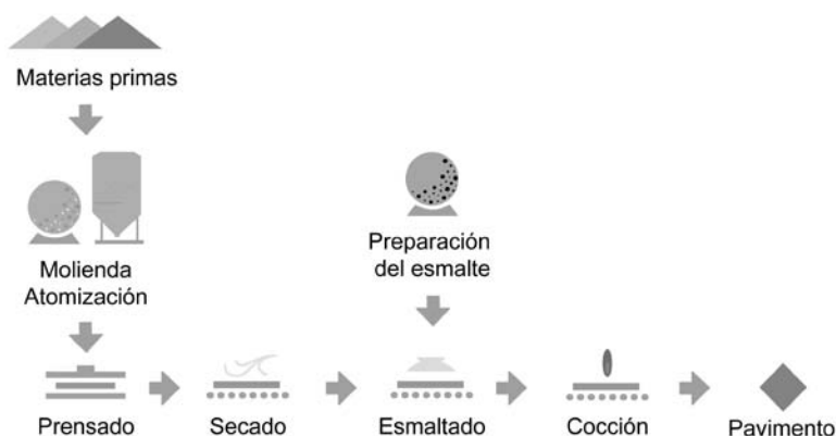
Figura 1. Proceso de fabricación de baldosas cerámicas.
